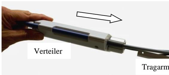
Verteiler am Tragarm aufstecken
