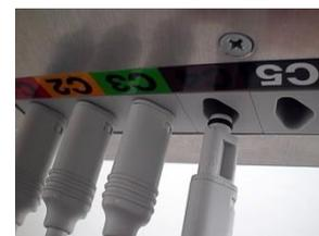
Elektrodenleitungen am Verteiler entsprechend den Codierungen einstecken.
